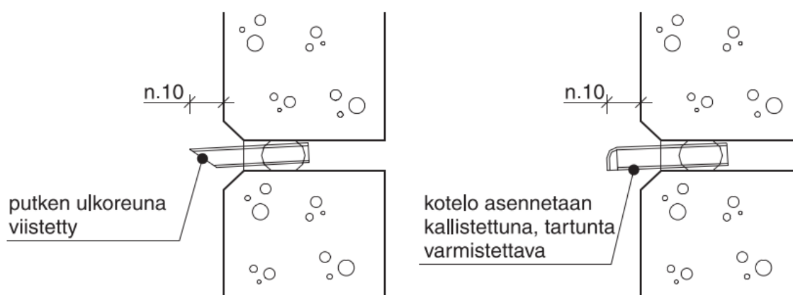
Kuva 4 Saumojen tuuletusratkaisu (RT 82-10766).
